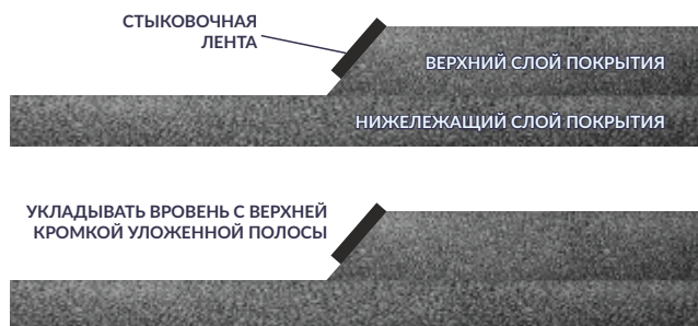
Схема фиксации ленты на кромку холодного стыка при параллельной укладке смежных полос
